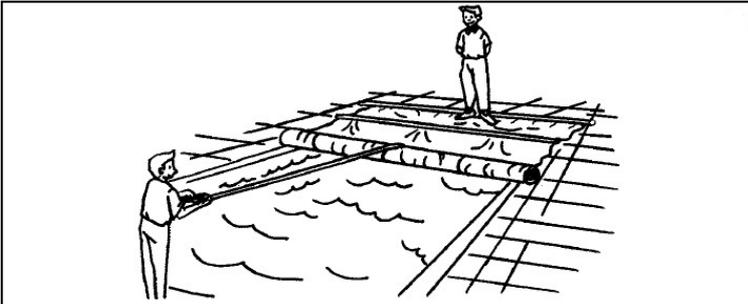
2) Den Planenrand niederhalten, während die Plane von der anderen Person mittels Front-Ausziehband ausgebreitet wird.
