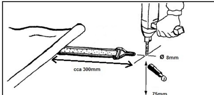
5) Die Plane muss im Beton oder im Pflaster auf der Betongrundplatte verankert werden. Falls sich ringsum das Schwimmbecken eine andere, als die oben erwähnte Oberfläche befindet, müssen die Scheiben mit einer Tiefe von min. 10 cm betoniert werden. Beginnen Sie, die Löcher an den Frontseiten der Plane mit einem Bohrer von  $\text{Ø } 8\text{mm}$  zu bohren. Die Löcher sind 75mm tief und ungefähr 300mm von der Plane zu bohren.
