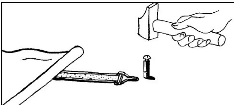
6) Die Verankerungsstifte mit Unterlegscheiben mittels Hammer befestigen.
