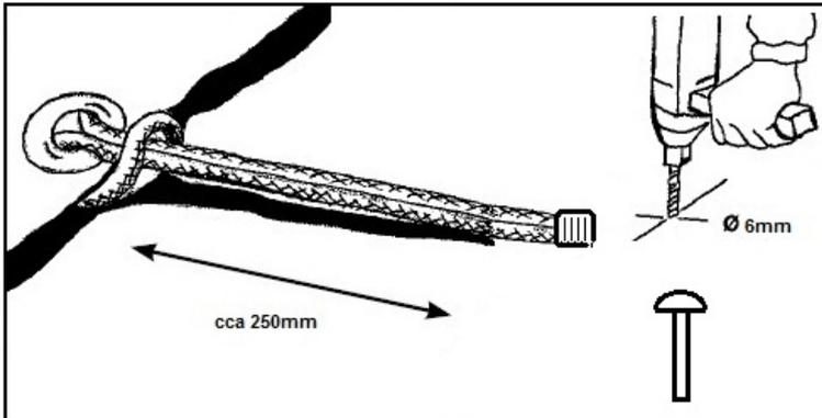
8) **Nach der Spannung** der Plane die seitliche Gummi-Spannvorrichtung auf der Schwimmbecken-Längsseite weiter spannen, die Bohrstelle markieren, die Spannvorrichtung lösen und ein Loch mit einer Tiefe von 75mm mittels Bohrer Ø 6mm bohren. Dann die seitliche Gummi-Spannvorrichtung über den Stiftkopf ohne Scheibe durchziehen.
