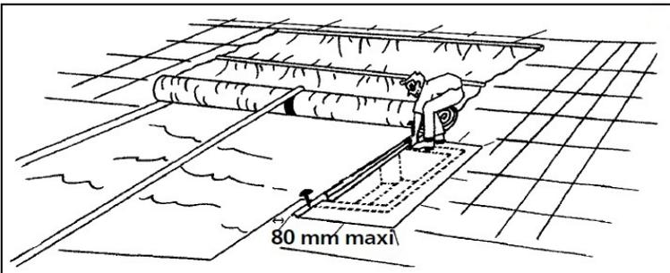
3) **Anmerkung:** Für Schwimmbecken mit Treppen auf der Längsseite über Treppe ein (mitgeliefertes) Rohr für Seitentreppe legen und die Plane mittels Front-Ausziehband weiter ausbreiten.
