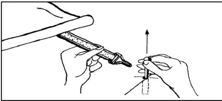
7) Die Steckstifte anheben und die Verankerungsbänder dazu befestigen. Die Plane mittels Ratschen spannen.
